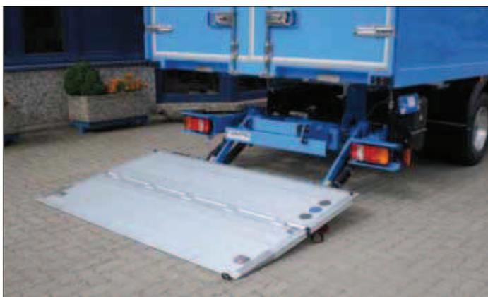
Kombinacja sprawdzonych części z DAUTEL LIFTER z nowymi inowacyjnymi komponentami gwarantuje przysłowiową niezawodność. Konstrukcja z 2 siłownikami podnoszącymi i 2 zamykającymi podwójnego działania zapewnia taki sam komfort załadunku co **DAUTEL LIFTER**, bo możliwe jest nastawienie nachylenia platformy.
